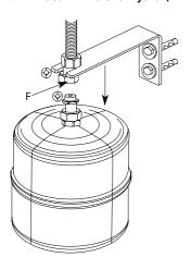
Консоль для подключения расширительного бака Uni-Fitt должна эксплуатироваться при давлении и температуре, изложенных в таблице технических характеристик (раздел 2).
