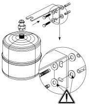
Консоль устанавливается в непосредственной близости от котла. Консоль подключается к подающему трубопроводу системы отопления трубой с проходным сечением не менее 15 мм; труба должна быть как можно короче, и на ней не должно быть никакой запорной арматуры.
