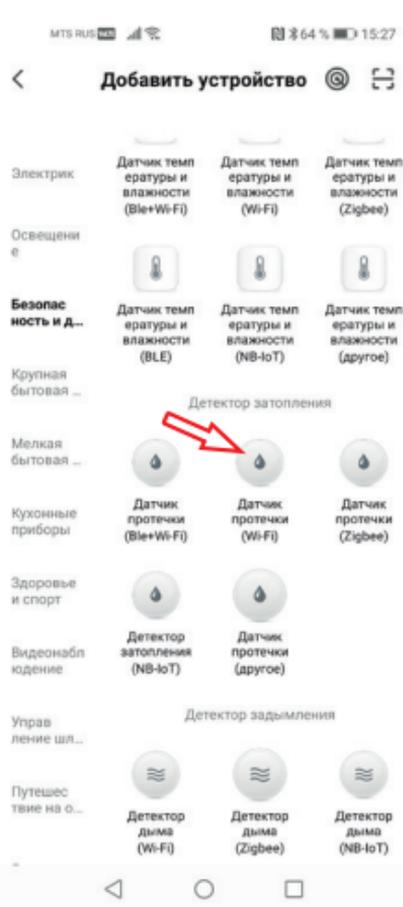
3. При подключении датчика протечки возможно потребуется сбросить его настройки путем нажатия и удержания (более 5-10 секунд) кнопки сброса до начала мигания светодиодного индикатора.
