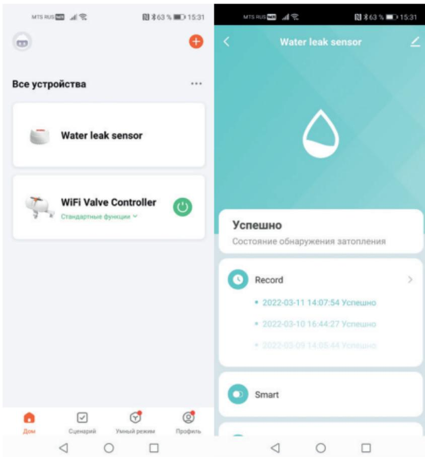
9. На вкладке «Smart» настраивается автоматическое управление другими устройствами по сигналу срабатывания датчика протечки воды Wi-Fi. Например, можно включить автоматическое закрытие воды Умным манипулятором GIDROLOCK.
